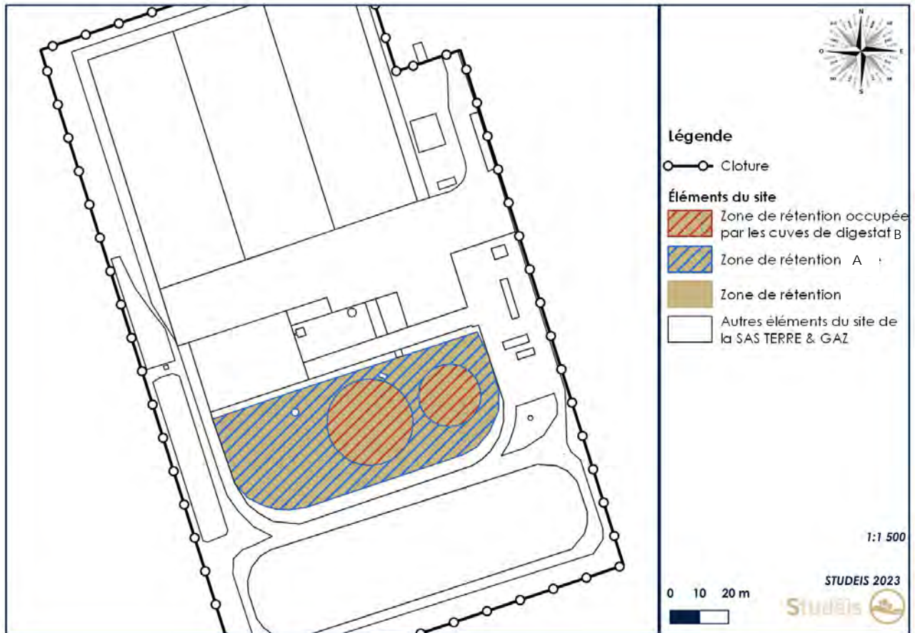
Figure 11. Zones de rétention de la SAS TERRE&GAZ
